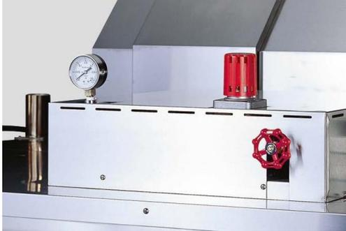
스팀 모델 ("S" 로 끝나는 모델 이름) 은 외부 스팀 발생기와 연결하여 스팀이 포함된 뜨거운 공기로 조리할 수 있습니다. 스팀 유입 양을 세가지 다른 레벨로 조정하여 특정 제품에 최적화 스팀 양을 맞출 수 있습니다. (스팀 모델에는 스팀 생성 기능이 없습니다. 개별 스팀 생성기가 필요합니다.)
